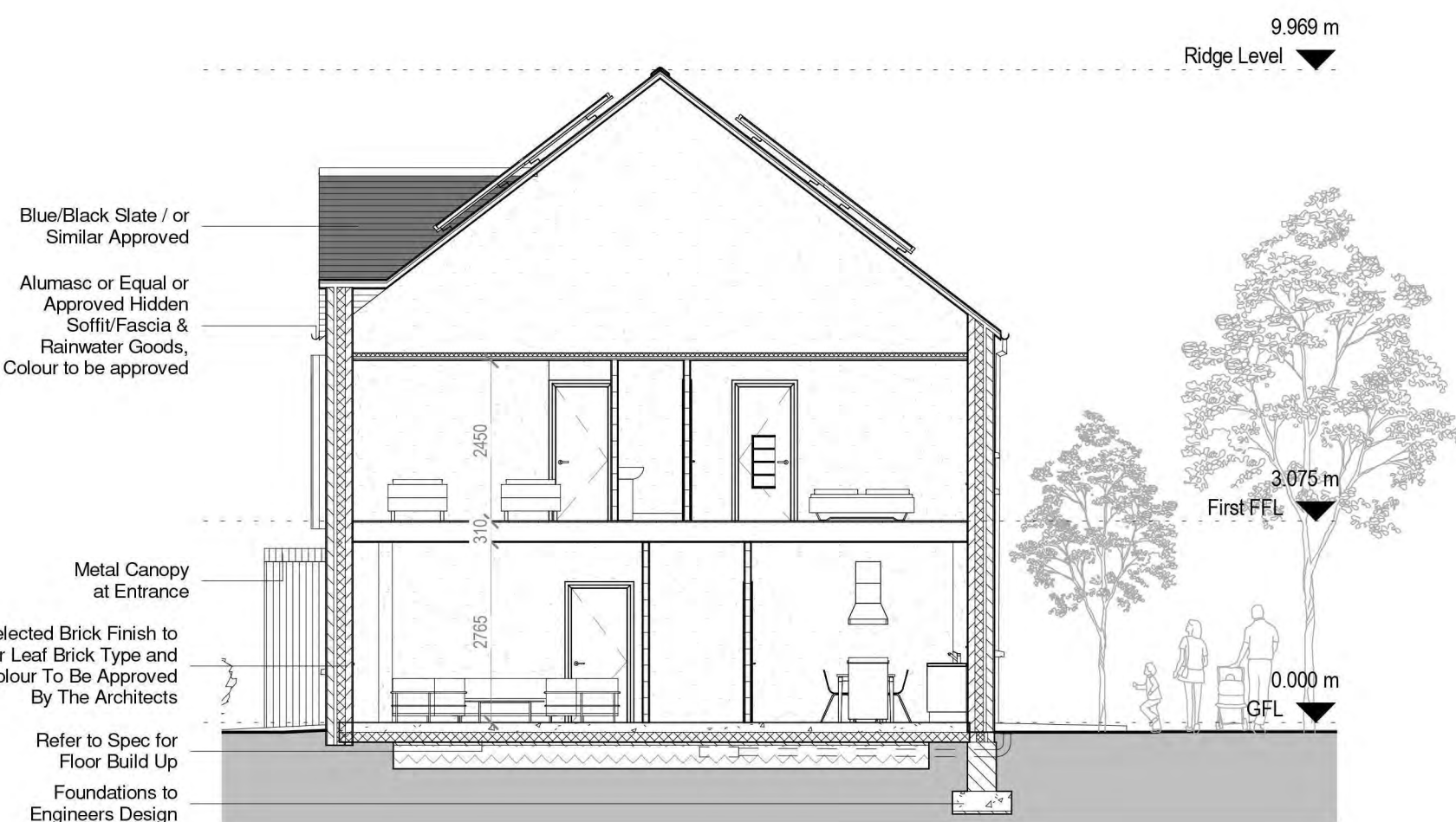
7 Block 4.5 - Section A-A 1 : 100
