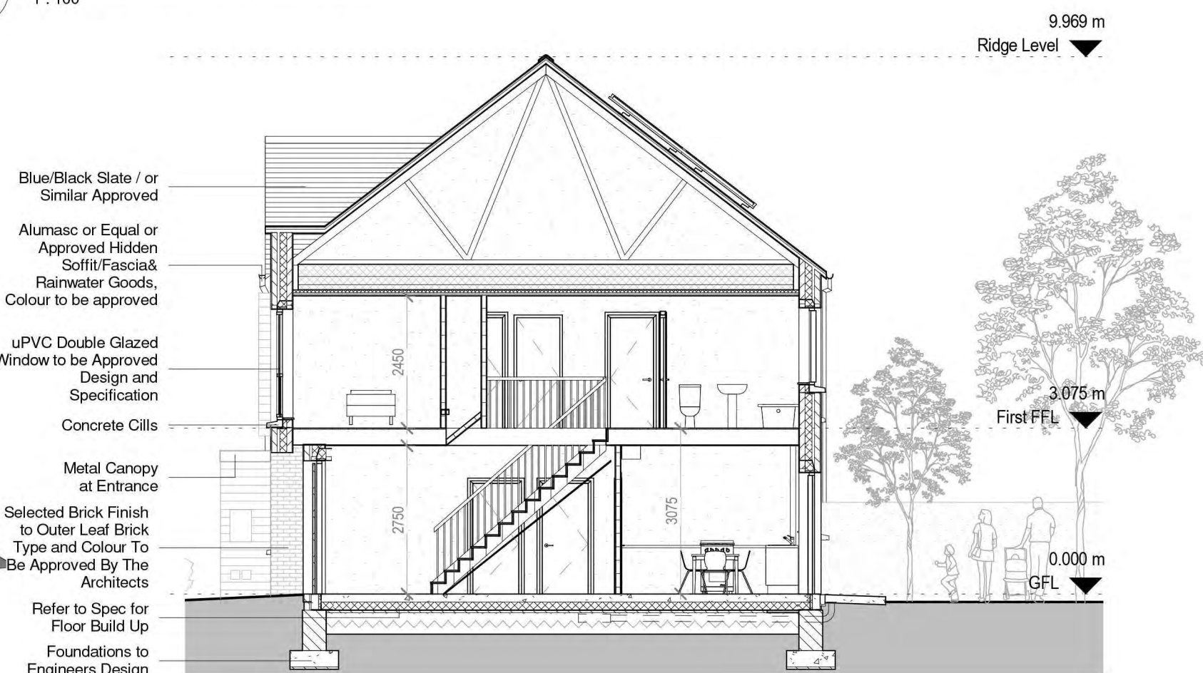
7 Block 4 - Section A-A 1 : 100
