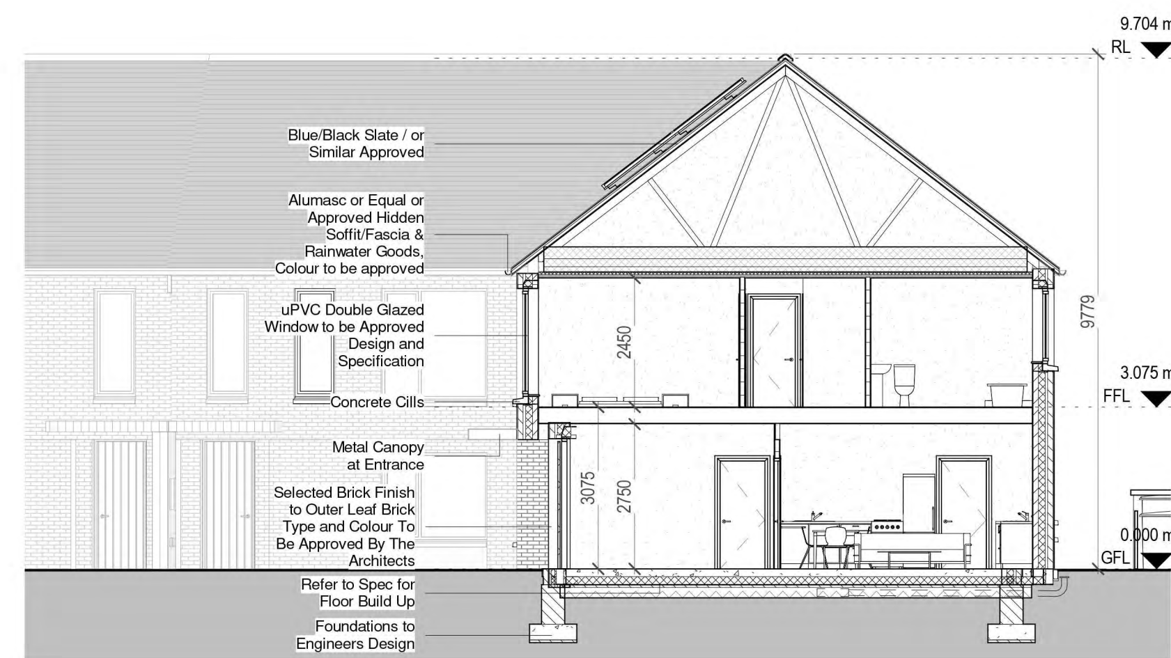
5 Block 6 - Section A-A 1 : 100
